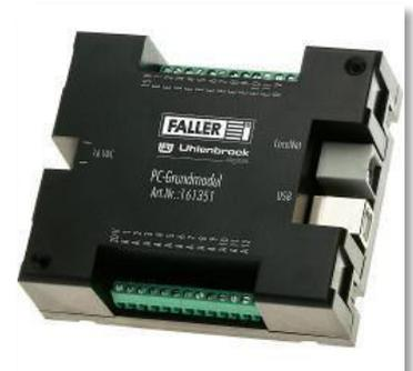
Fig. 3.34 Le Faller PC-Grundmodul
