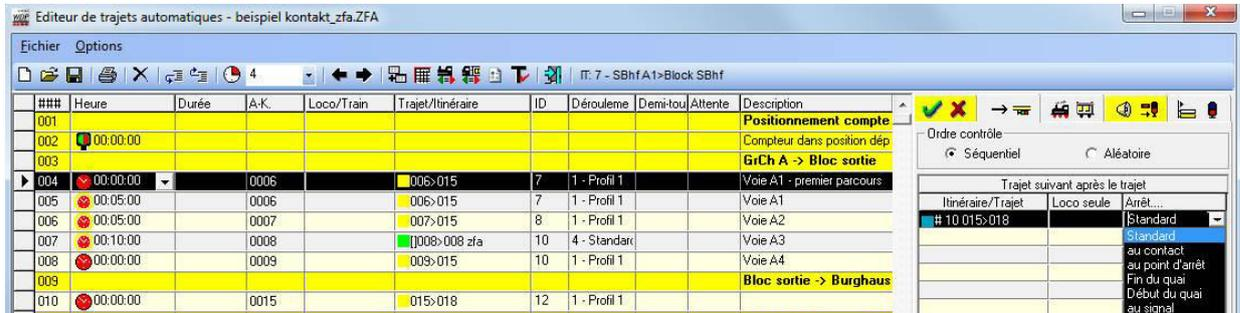
Fig. 9.28 La liste déroulante permet de définir la position d'arrêt sur une ESTi pour le trajet suivant ou la liaison suivante sélectionné
