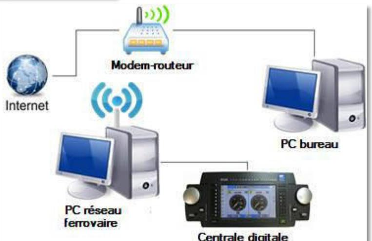
Fig. 3.6 Deux réseaux; le PC réseau ferroviaire avec connexion Wifi pour internet
