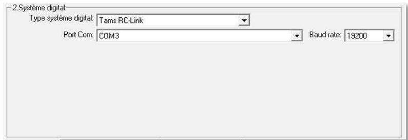
Fig. 3.74 Les réglages pour l'interface Tams RC-Link
