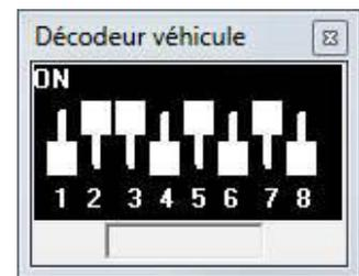
Fig. 4.16 Représentation des micro-interrupteurs d'une loco Märklin
