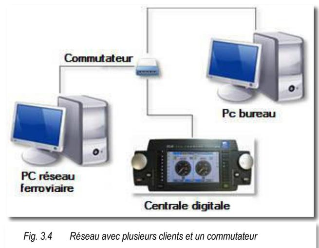
Fig. 3.4 Réseau avec plusieurs clients et un commutateur
